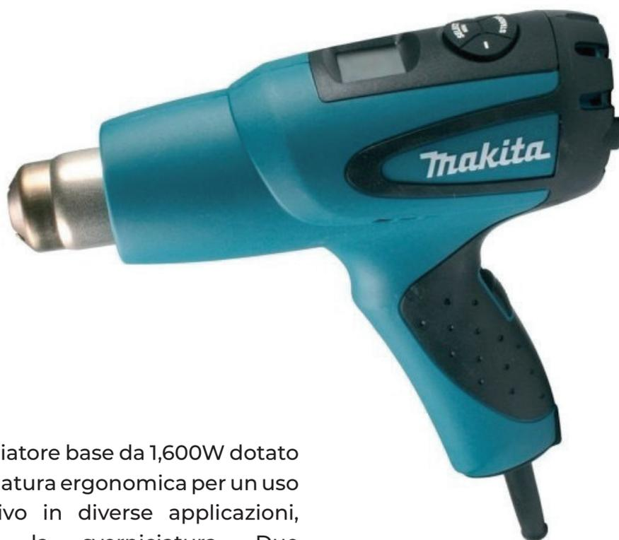
Termosoffiatore base da 1,600W dotato di impugnatura ergonomica per un uso impegnativo in diverse applicazioni, compresa la sverniciatura. Due impostazioni di calore e di flusso d'aria: velocità 1 - 350° per formatura, velocità 2 - 500° per termoretrazione, rimozione pitture, saldatura e operazioni di indoratura. Fornisce fino a 500L/min a 500°C.
