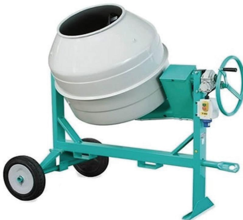
Progettata e realizzata per risolvere i problemi tipici delle betoniere tradizionali. Il sistema di trasmissione inserito nel braccio e il comodo sistema di ribaltamento a vite senza fine le rendono silenziose, leggere ed allo stesso tempo robuste ed affidabili.
