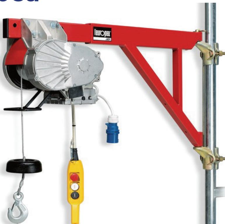
L'elevatore, chiamato anche paranco o argano, è un apparecchio di sollevamento costituito da un motore collegato ad un tamburo su cui si avvolge la fune, dotata di contrappeso e gancio di sollevamento.
