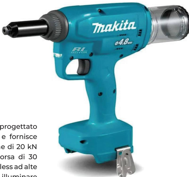
L'utensile è specificamente progettato per applicazioni industriali e fornisce una potente forza di trazione di 20 kN con una lunghezza della corsa di 30 mm. Dotato di motore brushless ad alte prestazioni. Doppio LED per illuminare la zona di lavoro. Freno motore elettrico per arrestare in modo immediato il motore in caso di necessità. È presente un contenitore trasparente per raccogliere i rivetti esauriti. Il sistema XPT permette l'utilizzo in presenza di polvere e gocce d'acqua.
